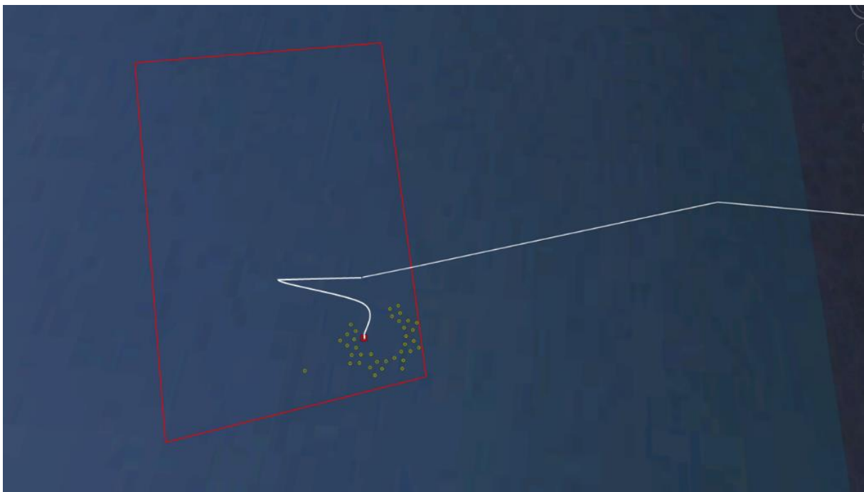
Figur 2: De 36 generatorerna (gulmarkerade) och ett undervattensställverk (rödmarkerad), som är placerad i vågkraftsparken i Sotenäs. På bilden syns också 52kV ESC (landkabeln).
