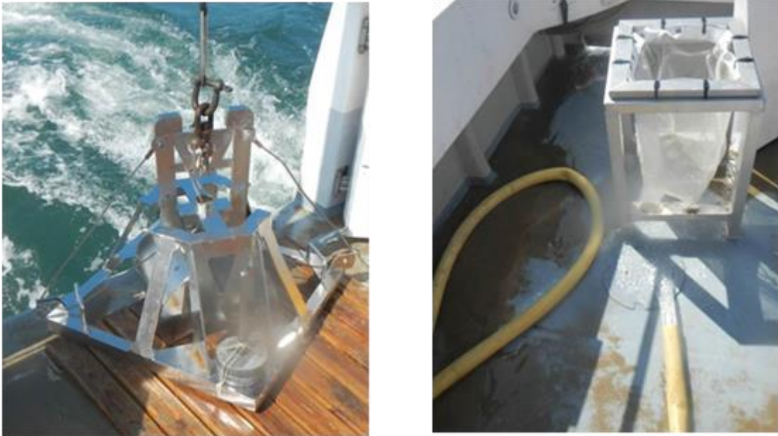
Figure 5 : Benne Day et tamis
