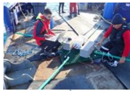
Cage instrumentée pour mesurer le CEM Taille : 1m*1m*0,2m Masse dans l'air : 50kg Les bras font 2m de long
