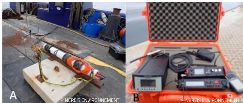
FIGURE 18 : PHOTOGRAPHIE DE L'ENREGISTREUR ACOUSTIQUE AUTONOME DEPLOYE POUR LA CAMPAGNE N°4 (A) ET DE L'HYDROPHONE EMBARQUE UTILISE POUR LA CAMPAGNE N°5 (B) (NEREIS ENVIRONNEMENT, 2020).
