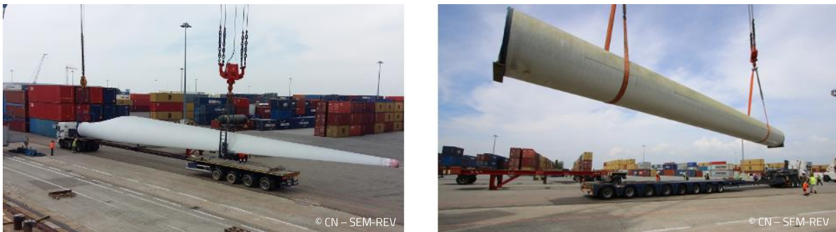
FIGURE 6 : PHOTOGRAPHIES D'UNE PALE (A GAUCHE) ET DU MAT (A DROITE) DE L'EOLIENNE FLOATGEN.
