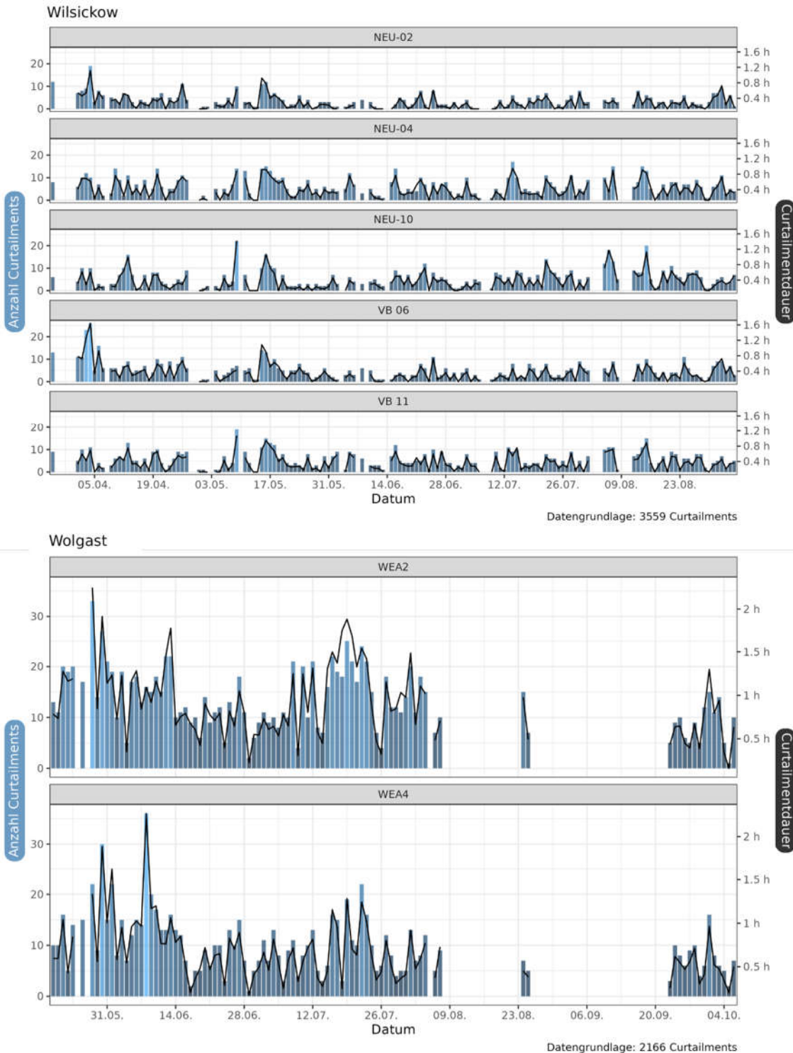
Abbildung 50: Anzahl und Dauer der Abschaltungen pro WEA durch IDF an den Standorten Wilsickow und Wolgast. In blauen Balken ist die Anzahl an Abschaltungen pro Tag angegeben, eine schwarze Linie zeigt die Dauer der Abschaltung an. Datengrundlage: Datenpunkte mit der IDF-Klassifizierung „White-tailed- Eagle“ sowie „Eagle“, die eine Abschaltung ausgelöst haben. Eingegangen sind nur ganztägige IDF-Erfassungstage bzw. Tage, an denen beide IDF-Systeme ganztägig verfügbar waren (Standort Wilsickow).
