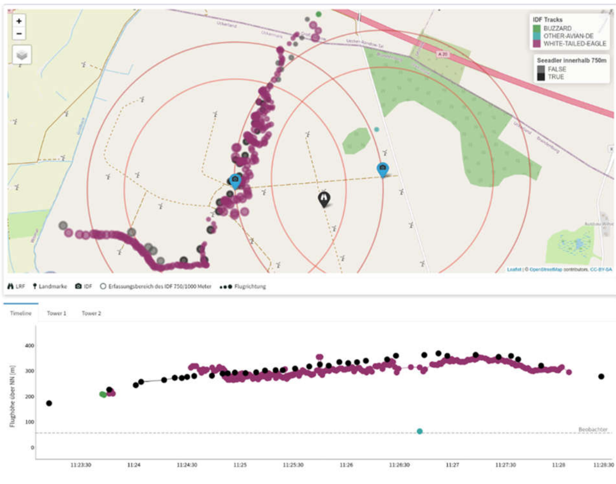
Abbildung 30: Beispiel für die Detektionsbewertung anhand des selbst programmierten Software-Tools. Der hier mittels LRF aufgezeichnete Seeadler (schwarze Punkte) wurde als „erfasst“ bewertet. Sowohl in der kartografischen Aufsicht des Tracks (oben) als auch in der graphischen Darstellung (unten) der Flughöhe über die Zeit wird deutlich, dass der Seeadler von den beiden IDF-Systemen erfasst wurde (violette Punkte).
