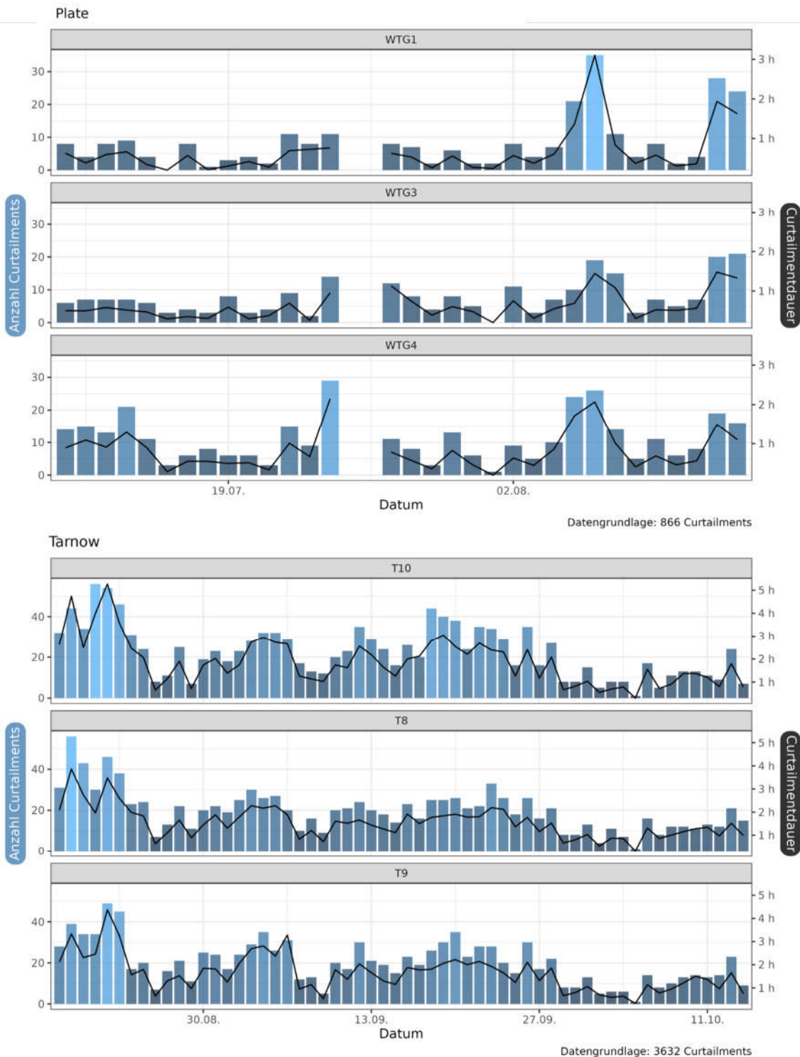
Abbildung 49: Anzahl und Dauer der Abschaltungen pro WEA durch IDF an den Standorten Plate und Tarnow. In blauen Balken ist die Anzahl an Abschaltungen pro Tag angegeben, eine schwarze Linie zeigt die Dauer der Abschaltung an. Datengrundlage: Datenpunkte mit der IDF-Klassifizierung „White-tailed-Eagle“, „Red-or-Black-Kite“ sowie „Protected“, die eine Abschaltung ausgelöst haben. Eingegangen sind nur ganztägige IDF-Erfassungstage.
