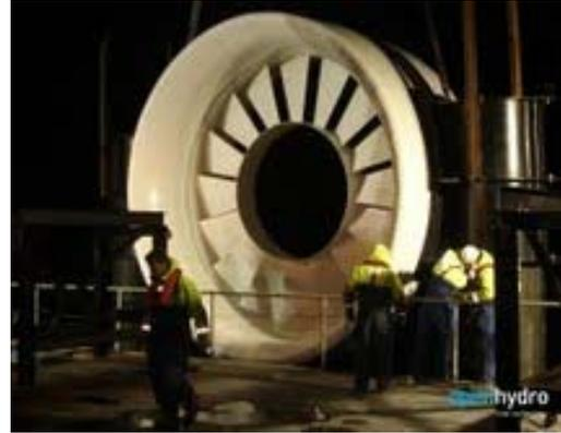
Figure 9. Open-Centre Turbine fan blade
