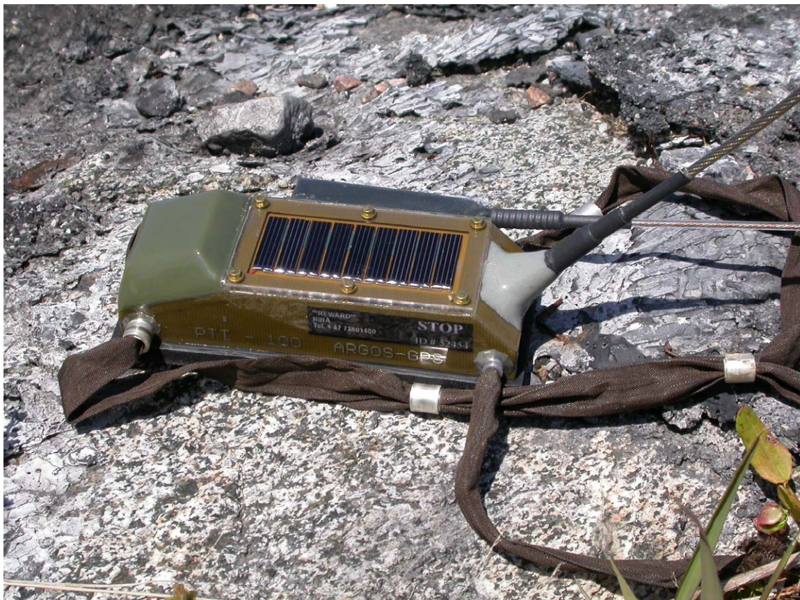
Figur 17. GPS-sender av typen Microwave Telemetry Argos/GPS med solcellepanel. – GPS transmitter of type Microwave Telemetry Argos/GPS with solar panel.
