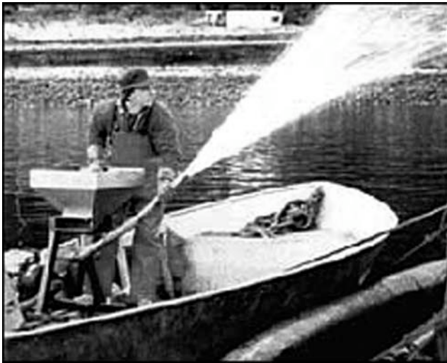
Abb. 19 Futterkanone ( Blitz Feeder ) der Firma NORFAB, die unter der Verwendung von Wasser das Futter in die Käfige befördert. NORFAB (1999)
