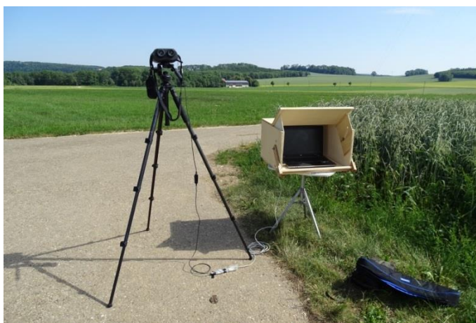
Abb. 11. Fotos des Laser-range finders mit Laptop, welcher sich in der Holzbox befindet (04.07.2019, J. Aschwanden). Foto of the laser-range finder together with the laptop which is in the wooden box.
