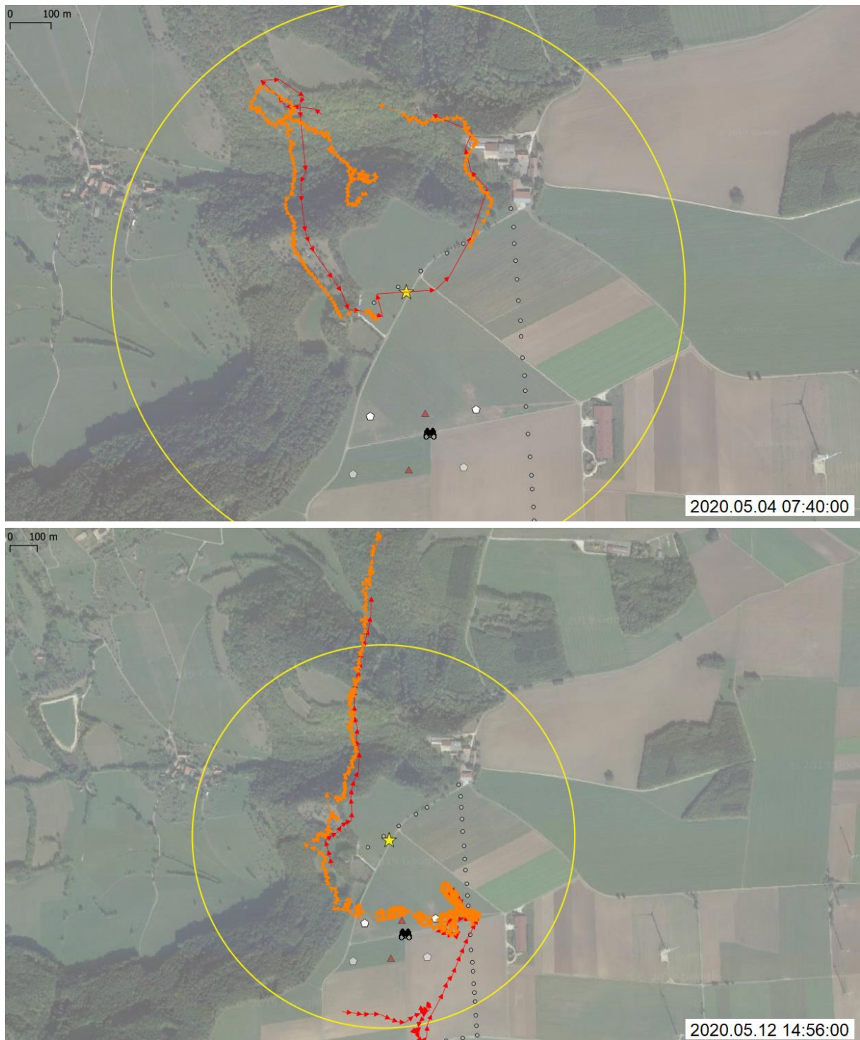
Abb. 26. Beispiele von LRF-Flugwegen (rot), die vom IDF (orange) detektiert worden sind. Examples of LRF-tracks (red) which were detected by IDF (orange).
