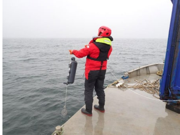
Prélèvements d'eau à la bouteille Niskin lors de la campagne de suivi des habitats benthiques de fonds meubles par IdraBio&Littoral.
